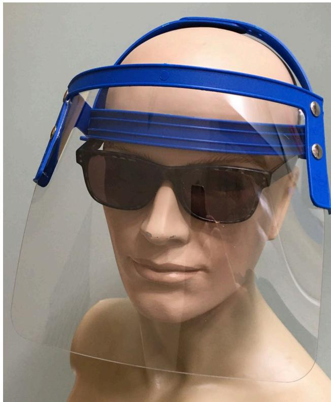
Realizzata tramite una struttura in polipropilene costituita da quattro sottoelementi: una fascia portaschermo, due semifascette superiori regolabili ad incastro maschio-femmina ed una fascia frontale portafeltro.
