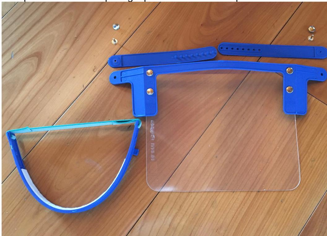
18) accoppiare in ordine: supporto feltro, fascetta con piolini e schermo con visiera. Attenzione alla testa bombata del rivetto che deve essere rivolta all'esterno, (come gli altri rivetti) e alla posizione della fascetta col feltro che deve avere i dentini di fermo corsa A rivolti verso lo schermo in basso. (non verso l'alto)
