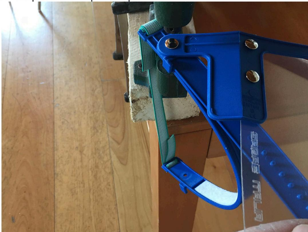
20) accoppiare l'ultima parte della visiera col seguente ordine: supporto feltro, fascetta con i fori e schermo con visiera. Attenzione alla testa bombata del rivetto che deve essere rivolta all'esterno
